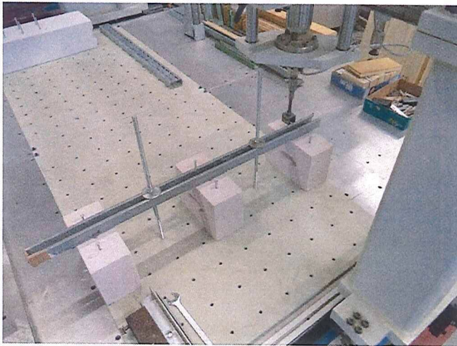
Abb. 1: Prüfanordnung für die Bestimmung der Auszugskräfte aus Kalksandlochstein
