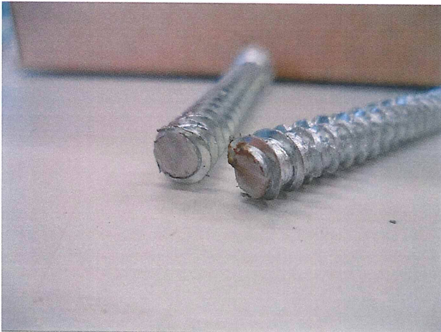
Abb. 3: Versagensbild eines abgescherten Rahmenankers
