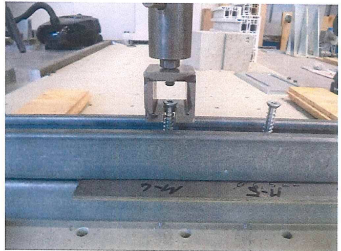
Abb. 2: Prüfanordnung für die Bestimmung der Auszugskräfte aus Metallblech
