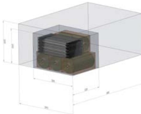
Pack- und Handling-Volumen reduzieren sich bis über 60 % im Vergleich zu einteiligen Dämmhaltern
