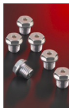
Śruba spustowa oleju z dwoma niezależnymi wgłębieniami (na rysunku Torx wewnętrzny z sześciokątem zewnętrznym) stosowana w obudowie przegubu podkaszarki. Wgłębienie Torx wykorzystywane jest w automatycznym procesie montażu na linii zaś sześciokąt zewnętrzny przewidziany jest do serwisowego demontażu w terenie.
