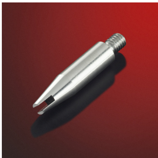
przykład: element toczoney z wyfrezowanym rowkiem pod śrubokręt i gwintem metrycznym.
