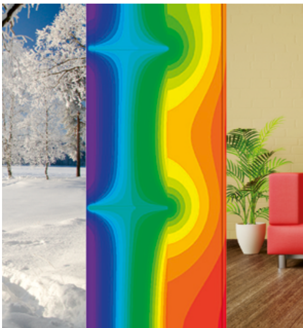
Abbildung 1 Ausgeprägte Wärmebrücke bei Aluminiumkonsolen
